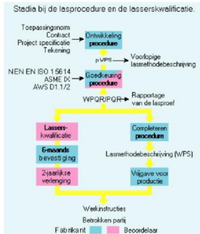
Figuur 1. Stadia bij de lasprocedure- en de lasserskwalificatie.
